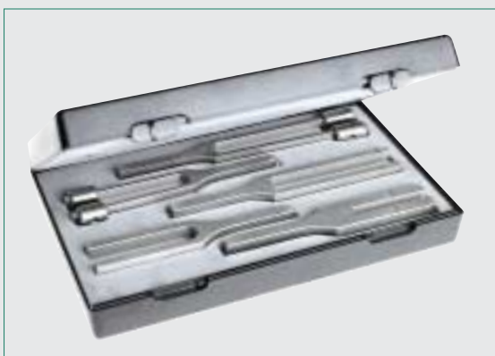
Nr. 5141 Juego II 5 diapasones de acero (n° 5161, n° 5164, n° 5166, n° 5168, n° 5170) en estuche de plástico
